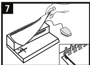
7 Снимите готовую брошюру с переплетного механизма.
