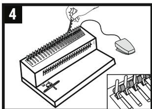
4 Поместите пластиковую пружину за держатель переплетного механизма зубцами вверх.
