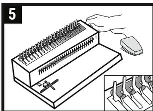
5 Используйте ручку разжима пружины на боковой панели, разожмите пружину.
