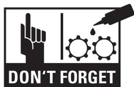
**X5, X8:** Смазывайте режущий механизм маслом при уменьшении производительности, возникновении шумов
