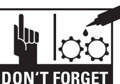
**X5, X8:** Lubrificați cu ulei aparatul de tăiat în cazul în care randamentul de tăiere scade, dacă apar zgomote sau după fiecare golire a recipientului pentru material tăiat. În acest scop, utilizați numai ulei special pentru blocul de tăiere HSM:
