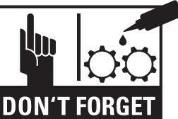
**X5, X8:** Naoljite rezalni mehanizem, če rezanje ni učinkovito, če se pojavi hrup ali po vsaki izpraznitvi posode za razrezane odpadke. Uporabiti je dovoljeno le specialno olje za rezalni blok HSM:
