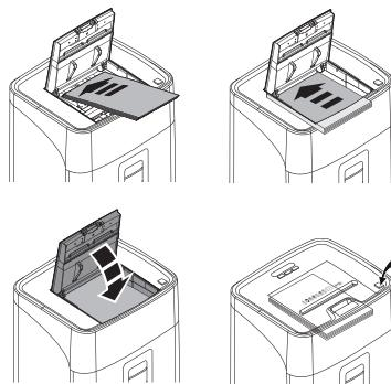
Для порционного уничтожения бумаги и уничтожения конфиденциальных данных в режиме автоподачи, поверните ключ в положение крышка слота атоподачи заблокируется.
