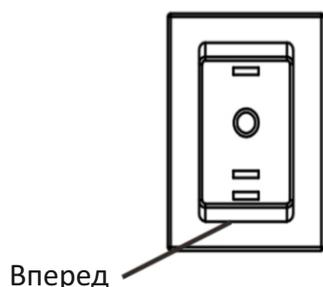
Нажмите кнопку "Вперед", чтобы включить двигатель перфоратора. Ножи аппарата начнут вращаться, готовые к подаче картона.
