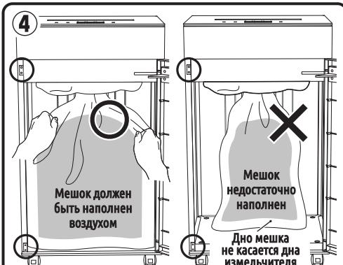
Держите мешок наполненным воздухом, чтобы он соприкасался с корпусом измельчителя.
