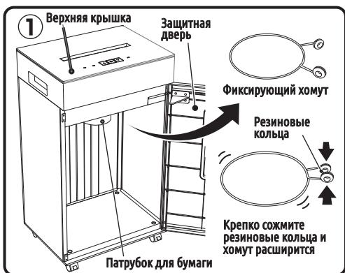
Откройте защитную дверцу, патрубок для бумаги будет закрыт, снимите фиксирующий хомут из патрубка для бумаги.
