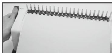
Поместите переплетаемый блок вместе с пружиной в зажимное устройство. Зажмите пружину с помощью ручки для переплета. Верните ручку в исходное положение.
