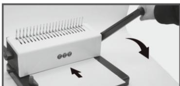
Вставьте переплетаемый блок в окно для перфорации. Зафиксируйте блок. Опустите ручку перфорации.
